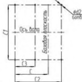
Схема расположения отверстий для крепления вентилятора ВР 132-30-12,5
